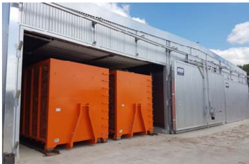
Cellule de séchage de bois
